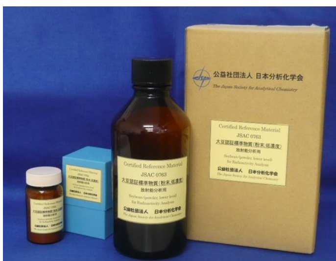
写真2 開発した放射能分析用大豆認証標準物質 (粉末状、低濃度) (JSAC 0762 及び JSAC 0763) ガラス製容器に充填され標準物質と梱包の箱。左 (JSAC 0762) ; 100 mL 容器、内容量 約 80 g、 右 (JSAC 0763) ; 1 L 容器、内容量 約 800 g。
