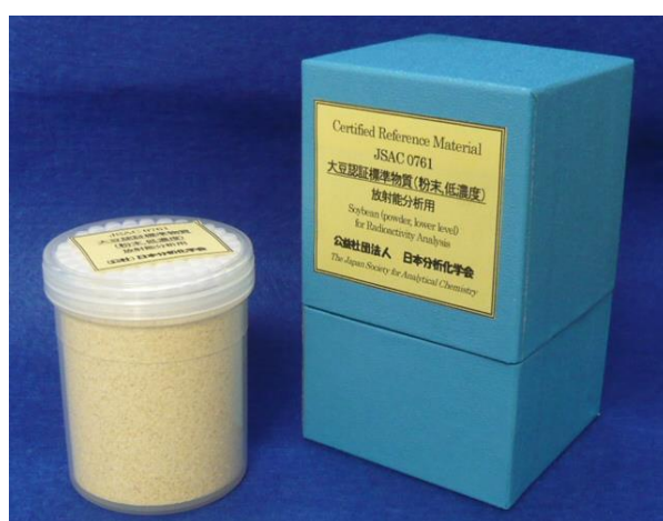
写真1 開発した放射能分析用大豆認証標準物質 (粉末状、低濃度) (JSAC 0761) ポリプロピレン製容器 (U8) 内に、高さが 50 mm になるように充填された標準物質と、梱包の箱。 容器上部にみられる白色部分は大豆が移動しないための充填剤です (内容量 75.0 g)。
